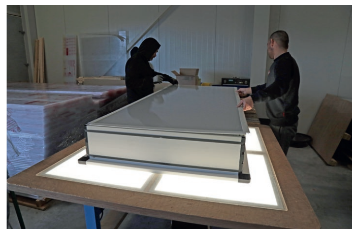
Laatste check van een daglichtsysteem op de lichtbak; een eventueel lek komt nu aan het licht.
