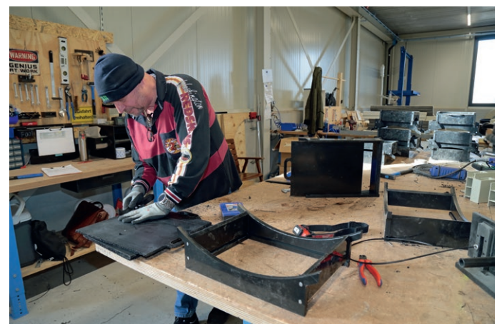
Kunststof schoonsnijden voor extrusielassen.
